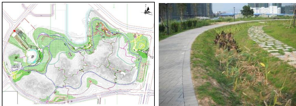
图 F4-4 公园平面图和植草沟实景图
