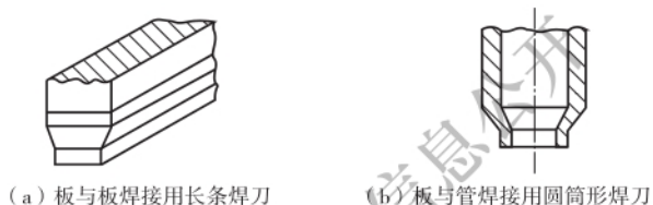
图 9.4.11-1 焊刀几何结构
