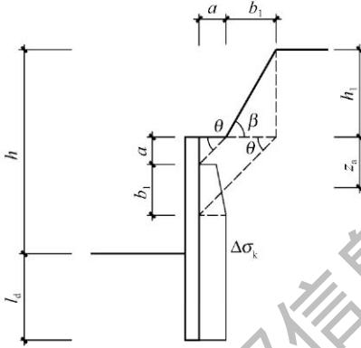
图 3.4.8 支护结构顶部以上采用放坡或
