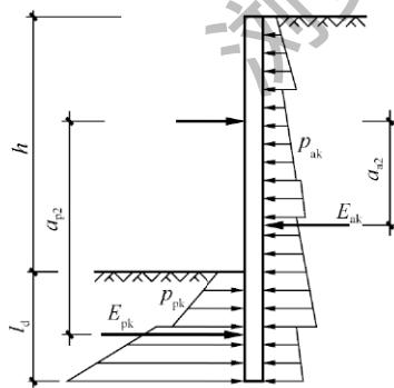
图 4.2.2 单支点锚拉式支挡结构和支撑式支挡结构的嵌固稳定性验算
