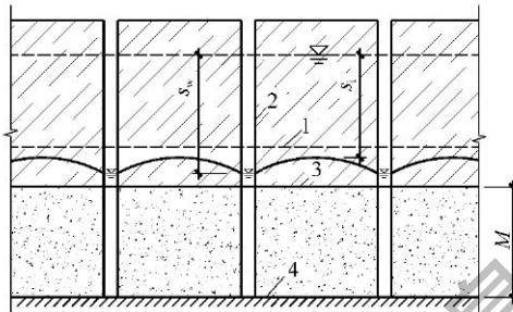
图 7.3.8 承压水完整井地下水位降深计算
