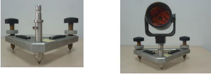
图 B 锚箱平面测量装置
