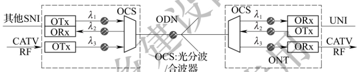
图 9.1.4 单纤三波长 FTTH 结构图
