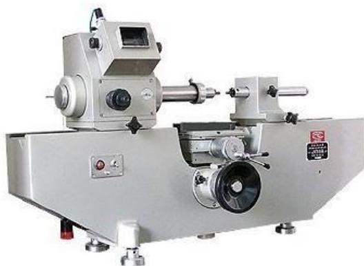
图 E.2-1 万能测长仪
