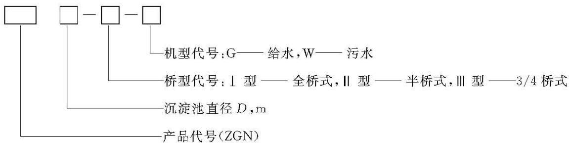
示例: 污水处理辐流沉淀池, 池子直径 25 m, 全桥式周边传动刮泥机标记为: ZGN 25-I-W。
