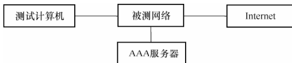
图 7.5.1-6 AAA 功能检测结构示意图
