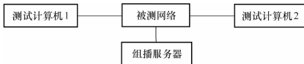
图 7.5.1-9 组播功能检测结构示意图
