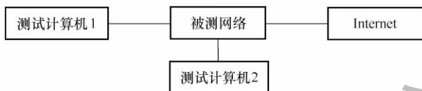
图 7.5.1-5 NAT 功能检测结构示意图
