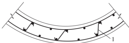
图 6.5.7 纵向钢筋与环向钢筋布置
